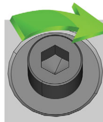
FIG. 41 STRINGERE LA VITE PER IMMOBILIZZARE IL BLOCCO
