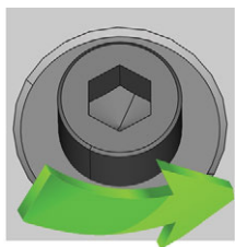
FIG. 38 SVITARE LA VITE NELLA POSIZIONE DESIDERATA
