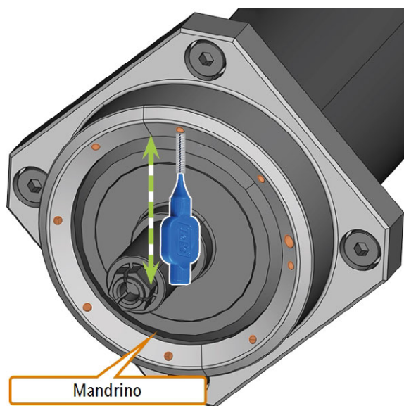
FIG. 91 PULIZIA DELLA PIASTRA DELL'UGELLO; UGELLI CONTRASSEGNA TI IN ARANCIONE
