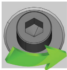
Abb. 44 DIE SCHRAUBE AN DER GEWÜNSCHTEN POSITION LÖSEN
