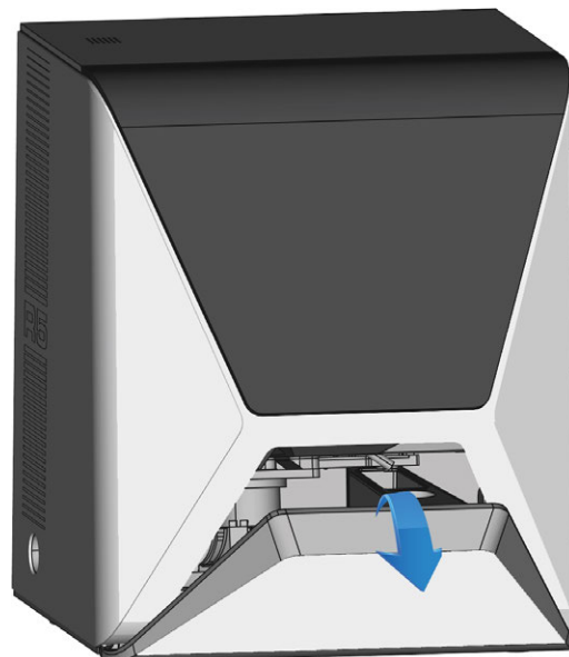
FIG. 61 TIRARE MANUALMENTE VERSO IL BASSO L'ALETTA DEL COMPARTIMENTO MULTIFUNZIONE
