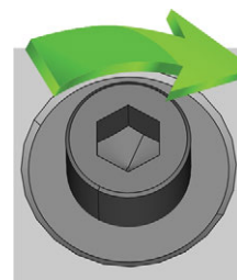
Abb. 47 SCHRAUBE FESTSCHRAUBEN, UM DEN BLOCK ZU FIXIEREN
