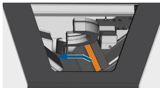
FIG. 67 RETIRADA DE LA BANDA PROTECTORA (MARCADA EN NARANJA)
