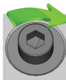
FIG. 47 APRETAR EL TORNILLO PARA INMOVILIZAR EL BLOQUE
