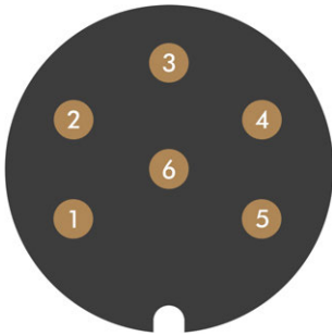
Abb. 8 PINBELEGUNG DES DATENPORTS DES ABSAUGGERÄTS
