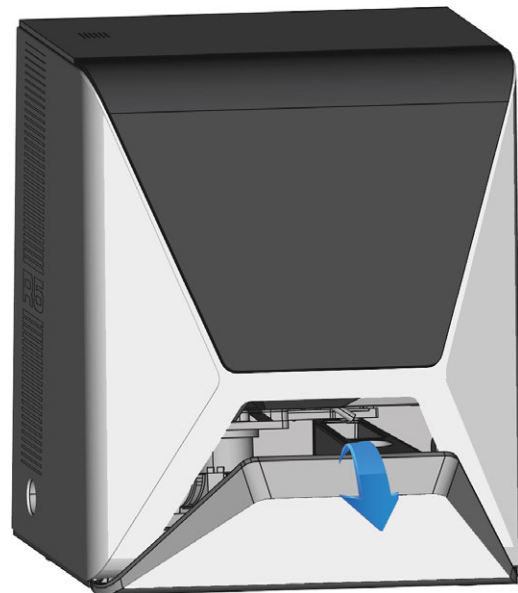
Abb. 61 Die Klappe des Kombifachs von Hand nach unten klappen
