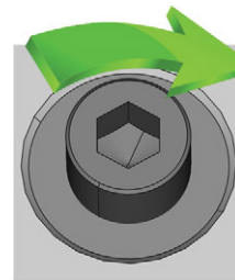
FIG. 47 VISSER LA VIS POUR IMMOBILISER LE BLOC
