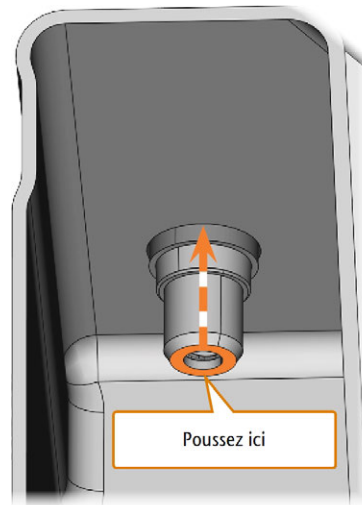
FIG. 109 EXTRAIRE LE COUPLAGE HORS DU RÉSERVOIR
