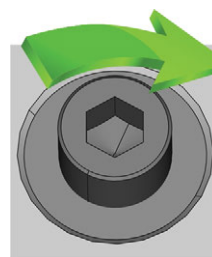
FIG. 25 VISSER LA VIS POUR IMMOBILISER LE BLOC
