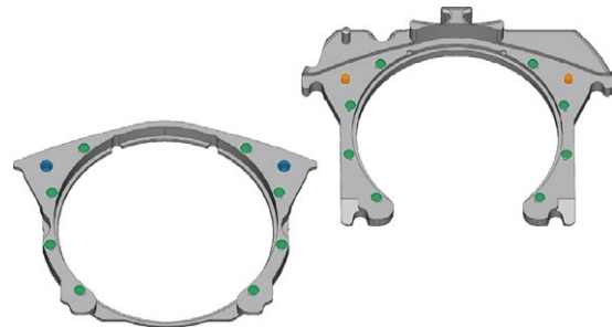
Abb. 33 ROHLINGSRAHMEN REINIGEN; MAGNETE GRÜN MARKIERT, POSITIONIERSTIFTE ORANGE MARKIERT, AUSSPARUNGEN BLAU MARKIERT
