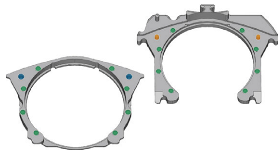
FIG. 33 NETTOYAGE DU CADRE DE PIÈCES BRUTES ; AIMANTS MARQUÉS EN VERT, GOUPILLES DE POSITIONNEMENT MARQUÉS EN ORANGE, ENCOCHES MARQUÉS EN BLEU
