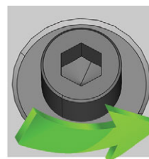
FIG. 21 DESATORNILLAR EL TORNILLO EN LA POSICIÓN DESEADA
